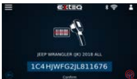
Scannez le VIN avec le pistolet et le VIN apparaîtra sur l'écran de l'outil
