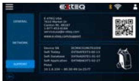
L'icône Support affiche les informations de l'outil et les informations de support technique. Le code QR sera disponible pour des guides rapides.
