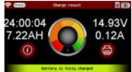
Después de 24 horas de carga (o <0,2 A) sin problemas, el resultado de la carga volverá a ser "La batería está completamente cargada".
