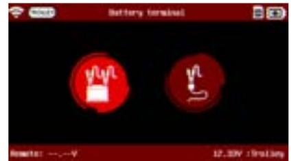
Seleccione el terminal de la batería si son accesibles. (Para Diagnóstico, siempre se recomienda probar en las terminales de la batería desnudas para obtener resultados más precisos).
