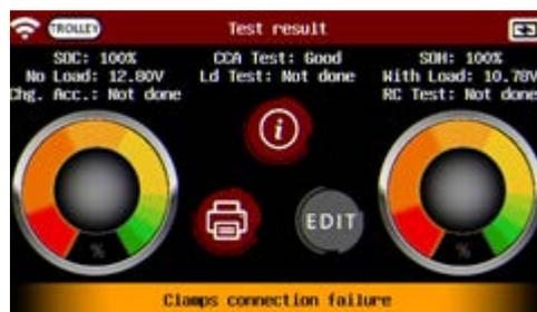
Si la prueba se interrumpe o las pinzas no detectan la batería correctamente, el resultado volverá a ser "Falla de conexión de las pinzas" y se deberá realizar la prueba nuevamente.
