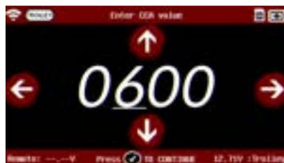
Use las flechas de navegación para ingresar el valor indicado en la batería (CCA SAE utilizado en este ejemplo)
