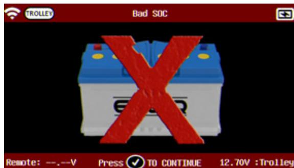
Si se detecta un valor incorrecto en el tipo de batería, la herramienta mostrará una batería con una X atravesada y emitirá un timbre audible simultáneamente.
