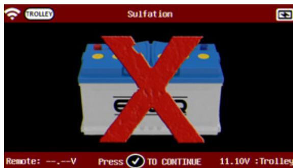
Si se encuentra sulfatación en la batería, la herramienta mostrará una batería con una X a través de ella y un timbre audible simultáneamente.
