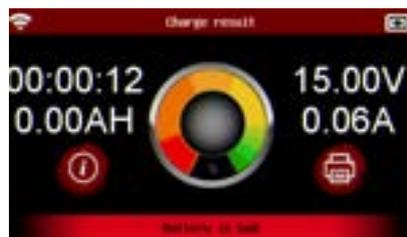
Después de presionar el
