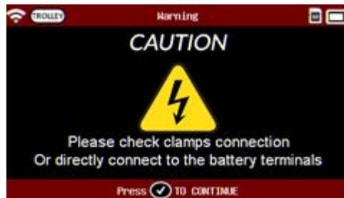
Si se encuentra un problema con la conexión de la batería, aparecerá la pantalla "Compruebe la conexión de las abrazaderas o conecte directamente a los terminales de la batería".
