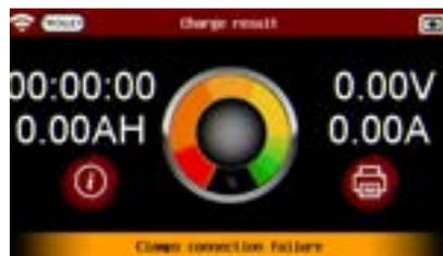
Si las pinzas no detectan la batería correctamente, el resultado será "Falla de conexión de la pinza" y se deberá realizar la prueba nuevamente.
