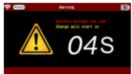
Si el voltaje de la batería es demasiado bajo, la herramienta realizará una precarga de la batería y luego continuará con la prueba de diagnóstico.
