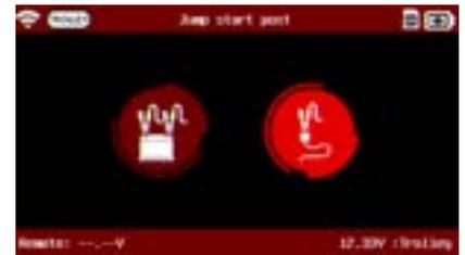
Si no se puede acceder a los terminales, seleccione el poste de inicio de puente (limita la corriente inyectada en el chasis a 40A)
