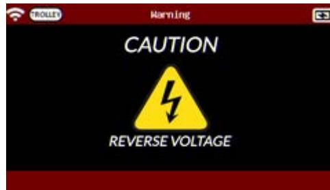
Si la batería está conectada en la polaridad opuesta, aparecerá la pantalla "Voltaje inverso".
