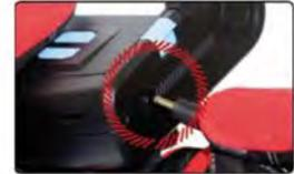
そして、USBミニケーブルをプリンタ本体左側面に接続します(2);もう一方のケーブルを充電器本体の背面にある、2つある左側コネクタ(PC/プリンタマークの下にある)に接続します(3)。
