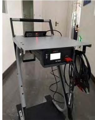
15mケーブル, AC電源とUSBコネクタを含んだ BC512用 E-XTEQトrolley
