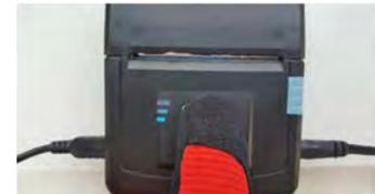
プリンタに電源が入り、それからセルフテストのチケットが印刷されます。(左の写真を参照)
